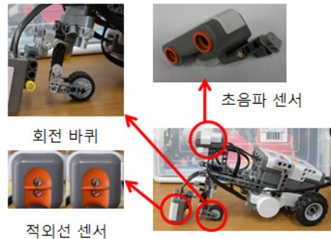
그림 3. 라인트레이서 센서 및 바퀴 Fig. 3. Line tracer sensor and wheels
